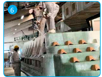
6 Proyectado con fibra de vidrio y resina exclusiva para la protección del laminado Projected with fiberglass and exclusive resin for laminate protection
