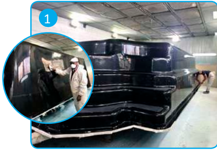
1 Preparación del molde y acondicionamiento para un fácil desmoldeo y una obtención final de gran calidad
