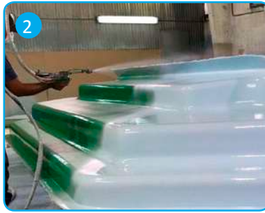
2 Aplicación de nuestro gelcoat exclusivo Application our exclusive gelcoat
